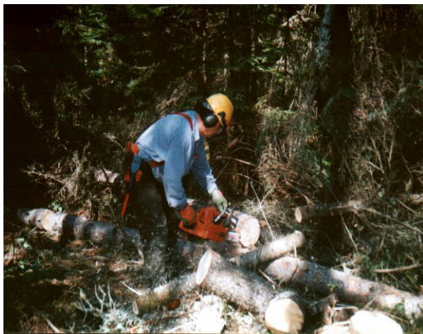
FIGURE 6 - TRONÇONNAGE D'UN ARBRE ÉCHANTILLON, PRÉLÈVEMENT DES RONDELLES ÉCHANTILLONS
