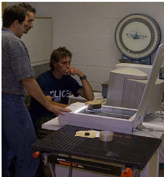
FIGURE 11 - NUMÉRISATION D'UNE RONDELLE ÉCHANTILLON
