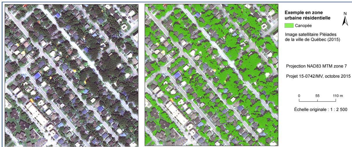
Figure 5 : Cartographie de la canopée (droite) et image satellitaire (gauche) pour une zone résidentielle de Québec
