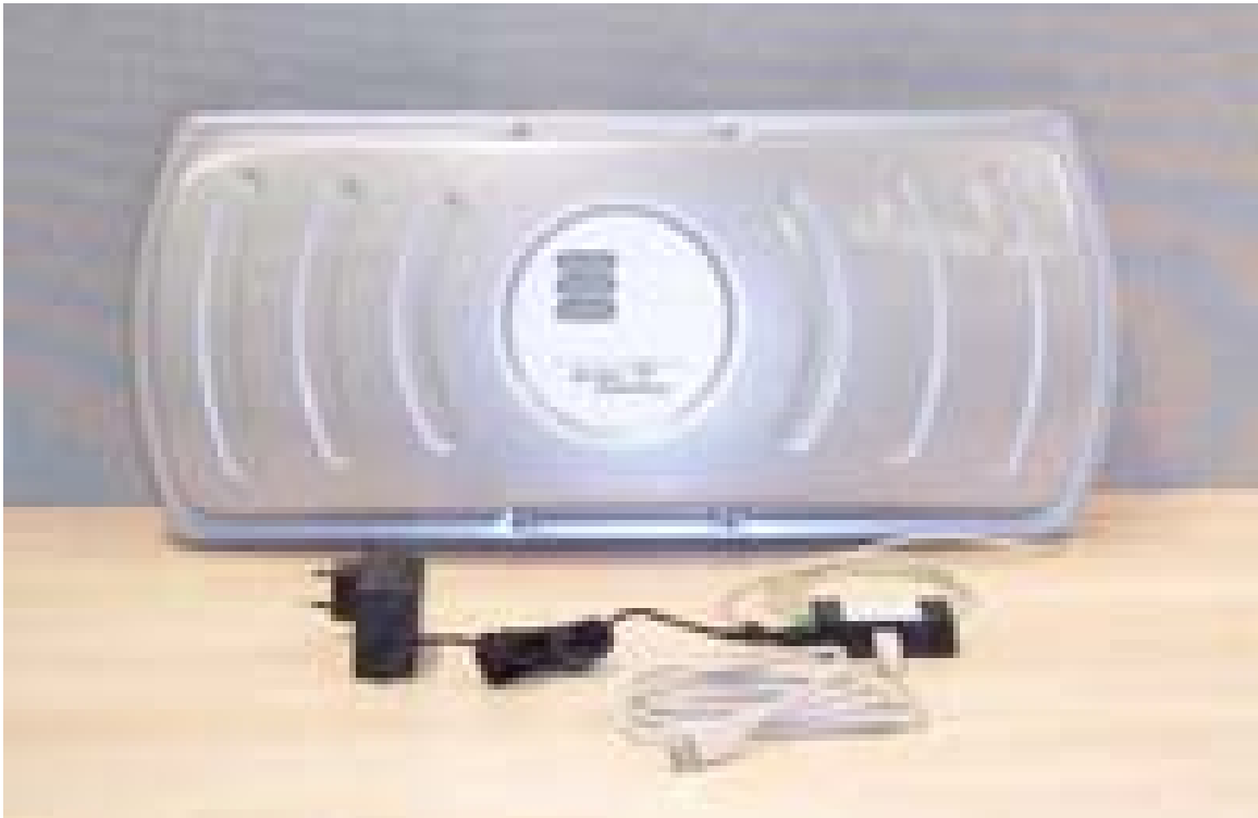
Figure 4 : Équipement RFID ultra-haute fréquence de la compagnie Atmel
