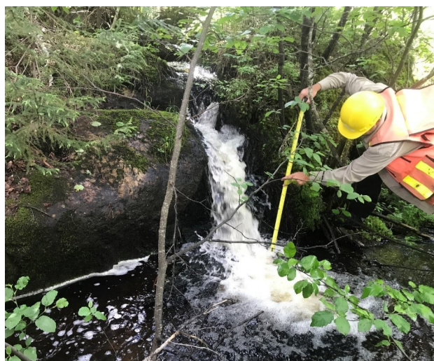
Figure 1 : Mesure d'une chute verticale en forêt.
