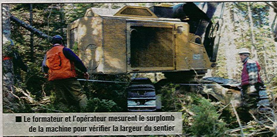
■ Le formateur et l'opérateur mesurent le surplomb de la machine pour vérifier la largeur du sentier
