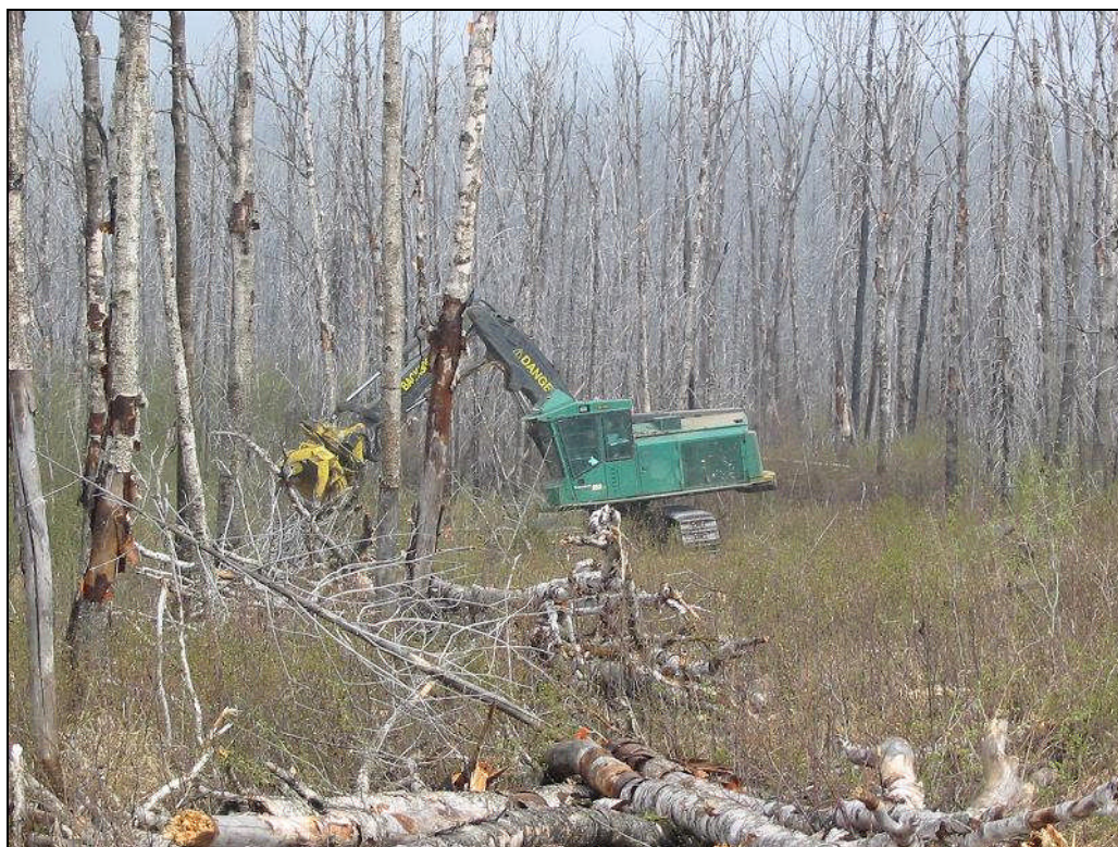
Figure 4 - Abattage de déblaiement à l'aide d'une abatteuse-groupeuse Timberjack 950 munie d'une tête de coupe Gilbert.
