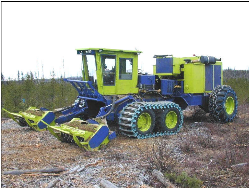
Figure 5 - La débroussailleuse à deux rangs Nokamic pour le traitement de dépressage.
