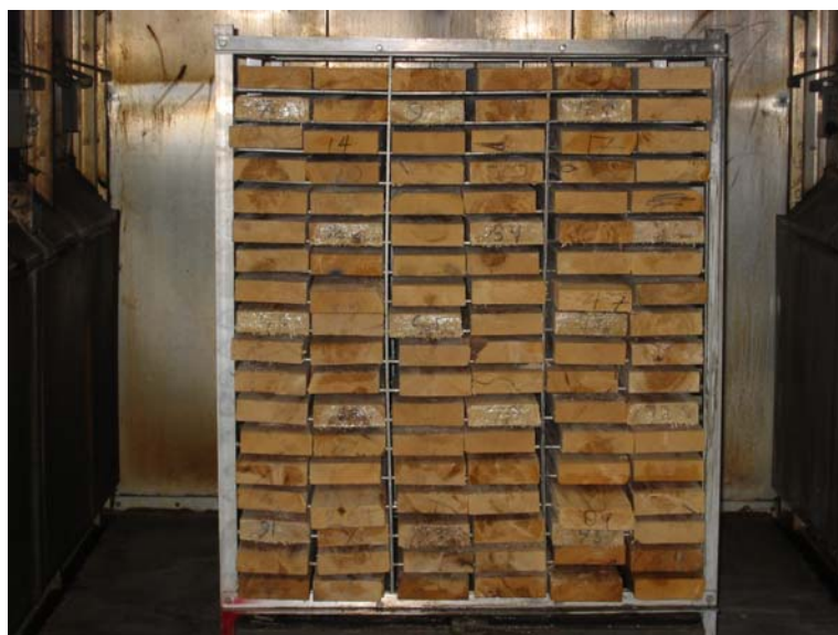
Figure 8 - Photo des pièces de bois dans le séchoir sur le support métallique
