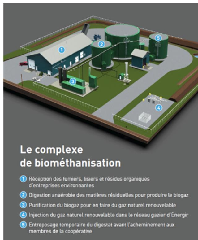
**FIGURE 2** Maquette d'un site de biométhanisation-type
