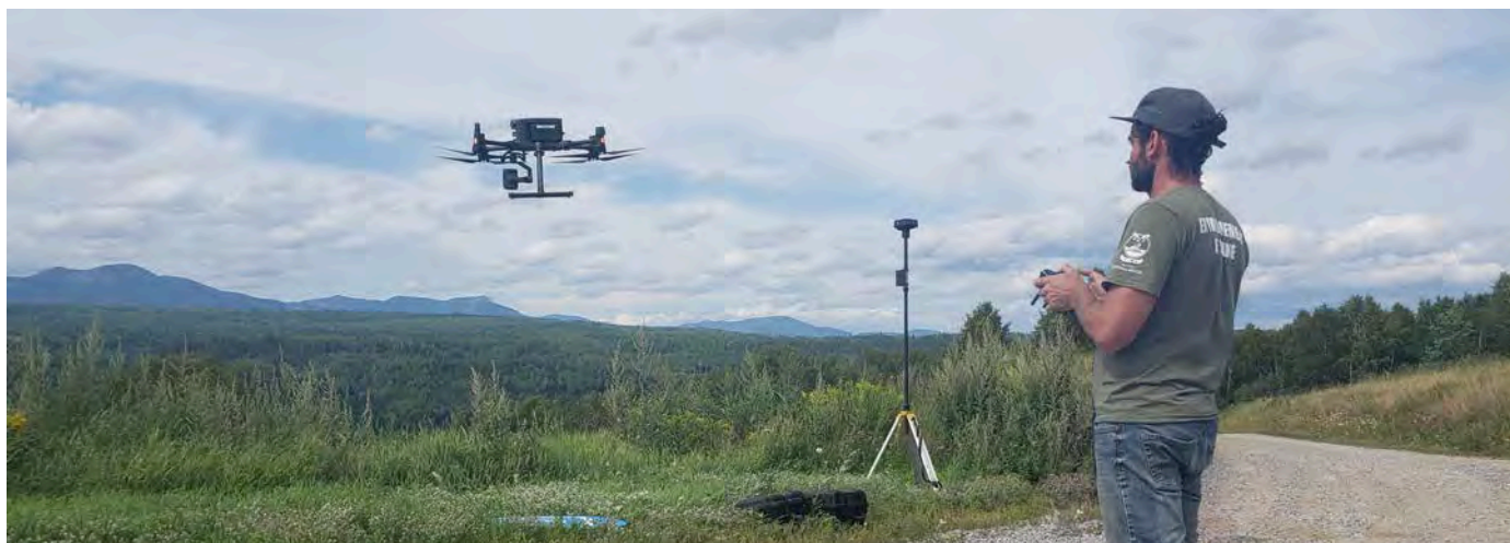
FIGURE 1 Utilisation du drone DJI M300 muni de la caméra H20T lors des acquisitions sur la rivière du Gouffre.
