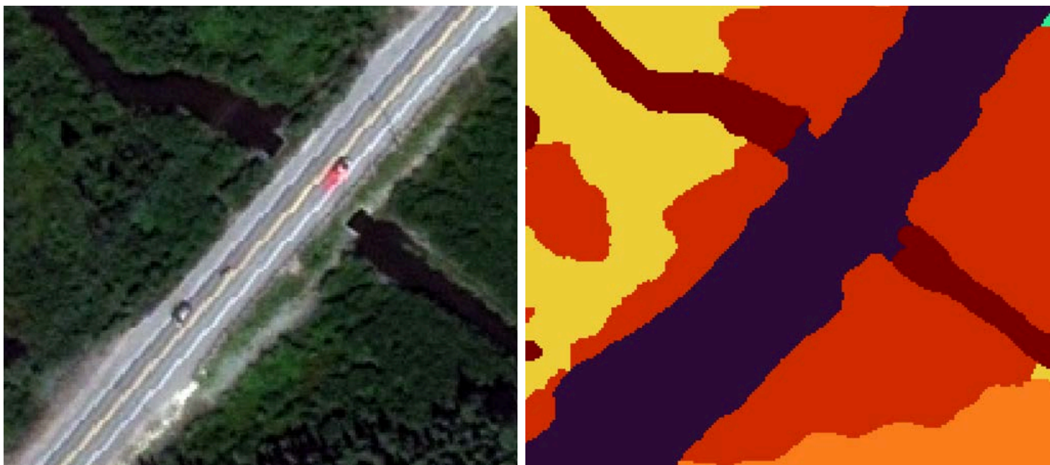
FIGURE 5. Exemple d'une imagerie (Worldview-3) utilisée lors de l'entraînement d'un algorithme de classification des combustibles forestiers. Les couleurs de l'image de droite représentent les classes utilisées.
