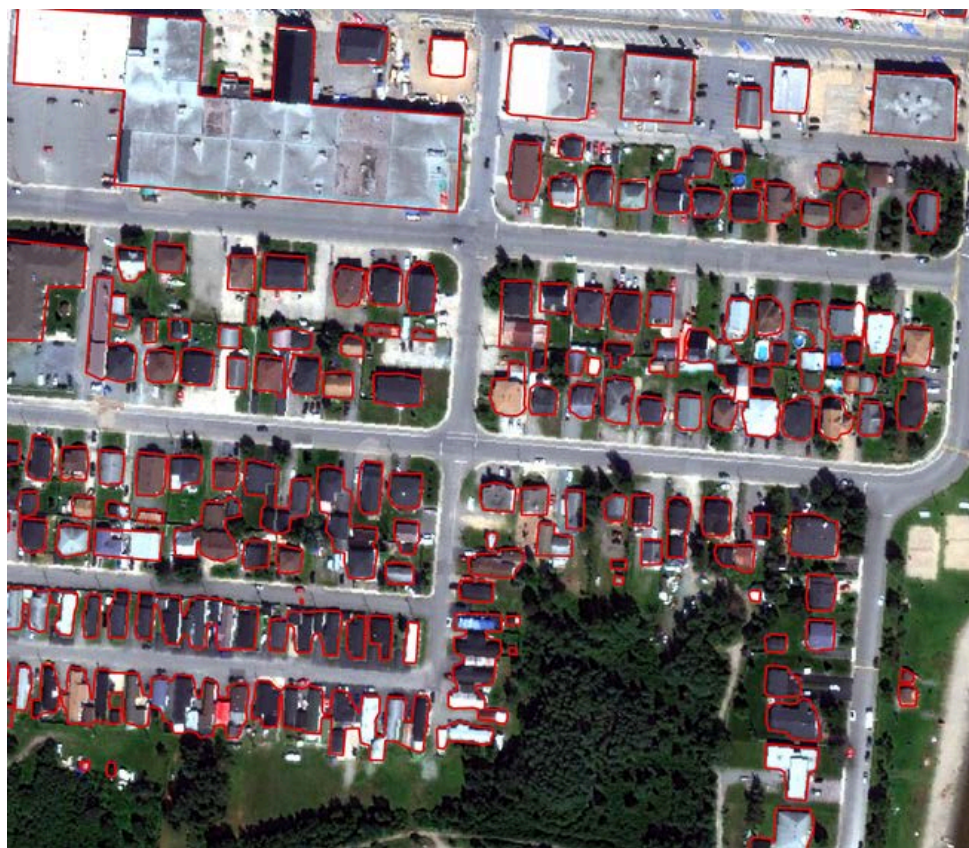
FIGURE 3 . Exemple de détection de bâtiments (contour rouge) à Chibougamau sur l'imagerie WorldView-3.
